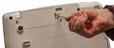
3. Poussez la languette pour retirer le couvercle du compartiment de la batterie.
