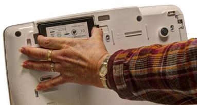
6. Placez la nouvelle batterie dans le compartiment et poussez-la jusqu'à ce qu'elle s'enclenche.
